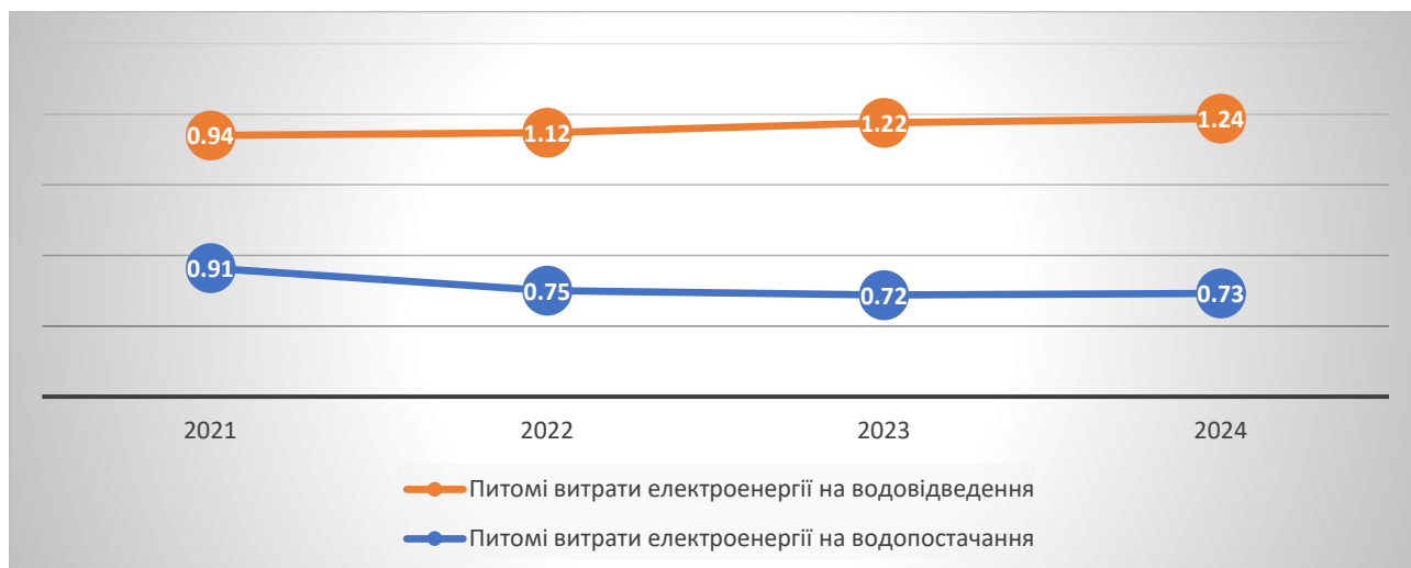
Рисунок 2.3.10. Динаміка питомих витрати електроенергії на водопостачання та водовідведення за 2021-2024 рр., МВт*год/тис. м 3
